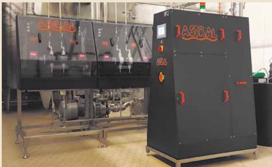
Abb. 4 Beispielanlage (vorne rechts) mit Dosierstationen (hinten links)
