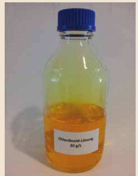
Abb. 1 Chlordioxidgas im Gleichgewicht über einer Chlordioxidlösung
